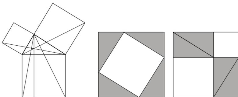
**Abbildung 2:** *Links:* Konstruktionsgeraden für Euklids Beweis des Satzes des Pythagoras. *Mitte und rechts:* Alternativer Beweis für den Satz. Die äußeren Quadrate haben die gleiche Fläche, und alle schattierten Dreiecke haben ebenfalls die gleiche Fläche. Daher hat das gekippte weiße Quadrat die gleiche Fläche wie die beiden anderen weißen Quadrate zusammen.
