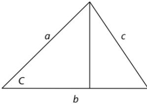
**Abbildung 6: Unterteilung eines Dreiecks in zwei rechtwinklige Dreiecke.**
